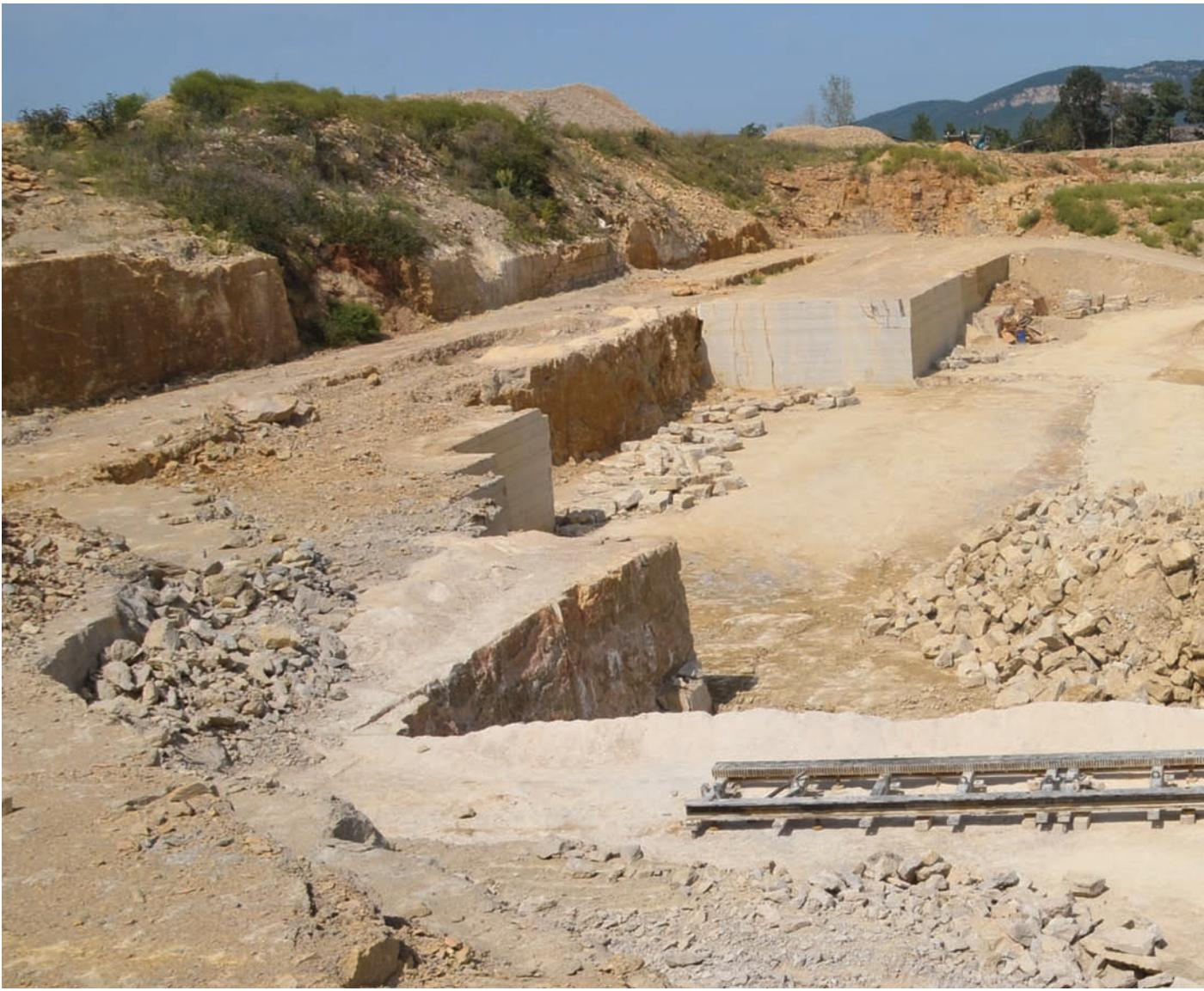
d'ores et déjà phasée sur trois périodes jusqu'en 2028. Le gisement se présente sous la forme d'un filon de 12 m d'épaisseur, avec un pendage moyen de 7 %, dont les six premiers mètres produisent des enrochements et des concassés. Ils recouvrent 6 m de roches ornementales, dont le front propose six bancs de pierre de Villebois, gris, jaune et bayadère.
