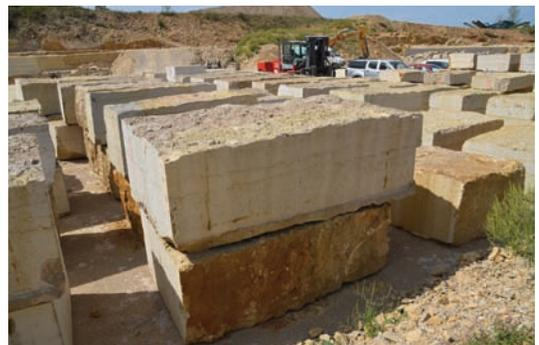
*Vues de la production de blocs de pierre de Villebois assurée par l'entreprise Saviane. Celle-ci a réalisé une campagne d'extraction cet été avec deux haveuses Garrone sur chenille. Celle utilisée sur le front de taille dispose d'un bras de 4,50 m avec chaîne diamantée, alors que celle utilisée pour l'équarrissage des blocs*
